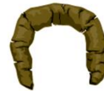
U-vorm met scheuren kleiig leem
